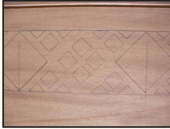
**ثانياً:** تستخدم أداة كهربائية للحفر، بعد أن يحدد النجار مقدار عمق الحفر، يقوم بحفر الأجزاء التي يرغب أن تكون غائرة.
