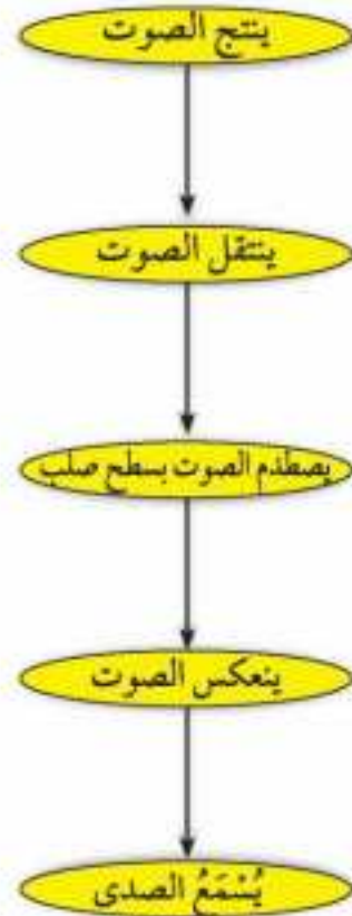
الشكل ٤ تظهر خريطة مفاهيم سلسلة الأحداث ترتيب الخطوات في عملية أو حدث. وتظهر سلسلة الأحداث هذه كيف ينشأ صدى الصوت.
