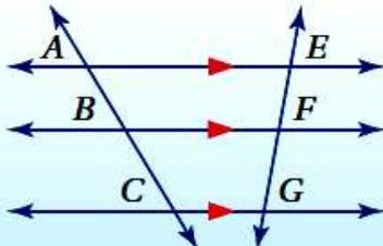
مثال: إذا كان  $\overline{AE} \parallel \overline{BF} \parallel \overline{CG}$ ، فإن  $\frac{AB}{BC} = \frac{EF}{FG}$ .
