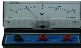
يستخدم لقياس الجهد الكهربائي في الدائرة الكهربائية ( يوصل على التوازي مع أجزاء الدائرة الكهربائية ) .
