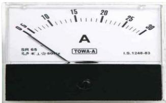
يستخدم لقياس التيار الكهربائي في الدائرة الكهربائية ( يوصل على التوالي مع أجزاء الدائرة الكهربائية ) .
