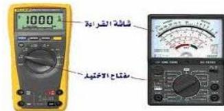
يستخدم لقياس كل من التيار الكهربائي و الجهد الكهربائي .
