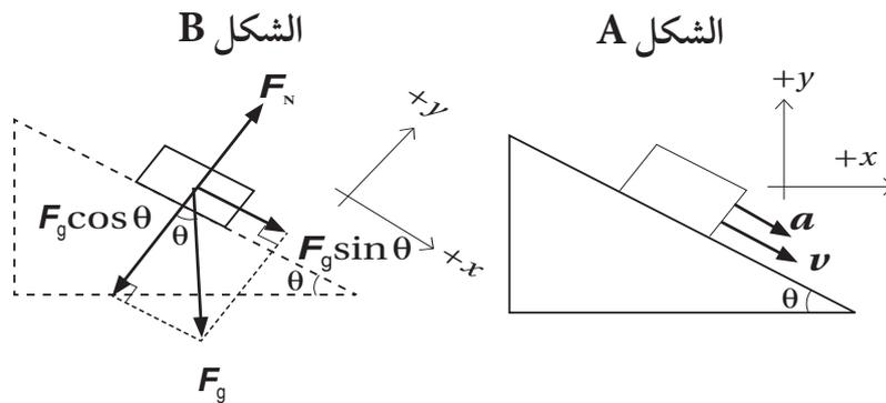
إلا أنه يصبح من السهل تحليل قوة الجاذبية الأرضية المتجهة إلى أسفل إلى قوة عمودية على السطح المائل وأخرى موازية له عند تدوير النظام الإحداثي، بحيث يصبح المحور  $x$  موازياً للسطح المائل. إن القوة الموازية للسطح المائل تجعل الصندوق يتسارع إلى أسفل السطح، ويوضح الشكل B مخطط الجسم الحر للقوى التي تؤثر في الصندوق. ويلاحظ أيضاً أن النظام الإحداثي يميل بزاوية يكون فيها المحور  $x$  في اتجاه يوازي السطح المائل. ويمكن إثبات أن المركبة
